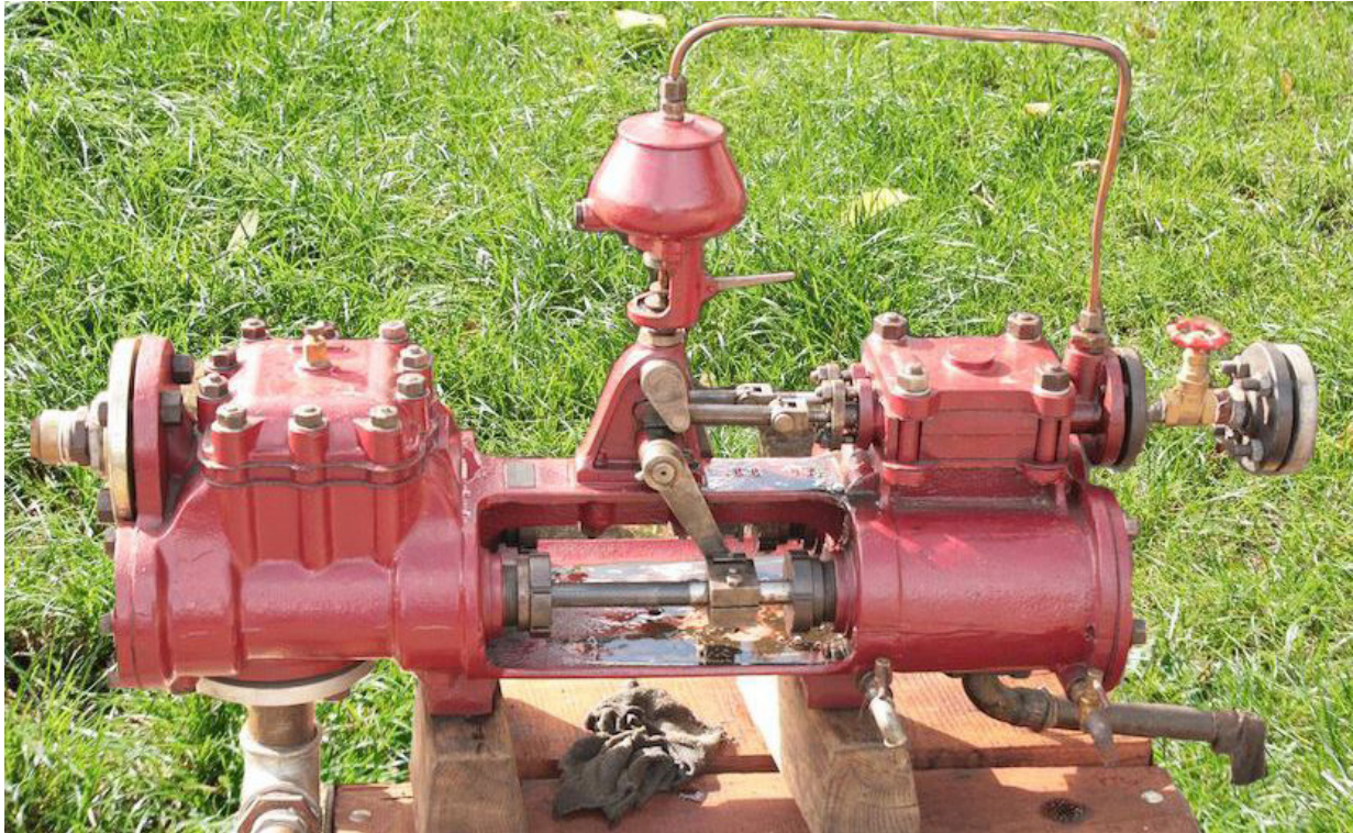
Abb. 9: Liegende Duplex-Dampfmaschine (Foto: T. Kettner, Weise u. Monski Dampfmaschinenmuseum e.V. Hanau-Großauheim).
